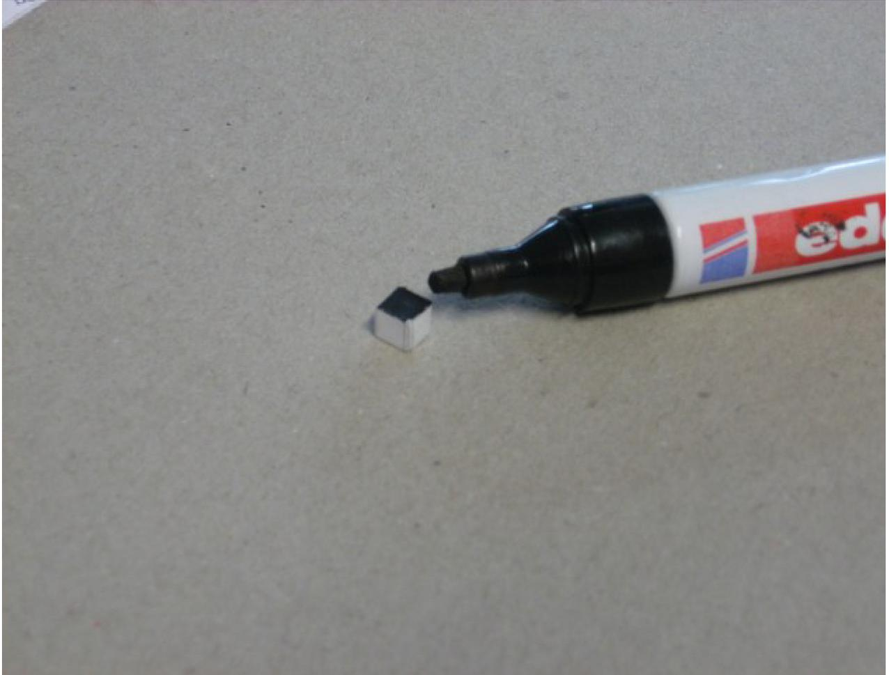
**Der/die Würfel werden z.B. mit einem Edding schwarz eingefärbt.**
