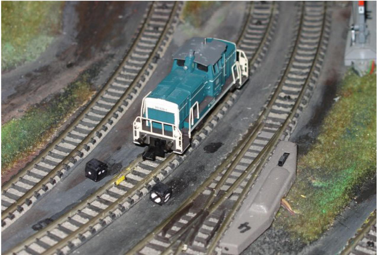
**Gleissperre in geöffnetem Zustand.**
